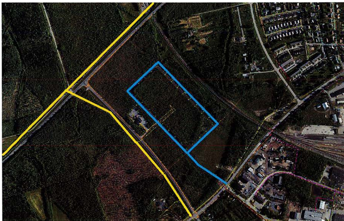
Vatten och avloppsledningar är markerade i blått, luftledning är markerad i gult.
